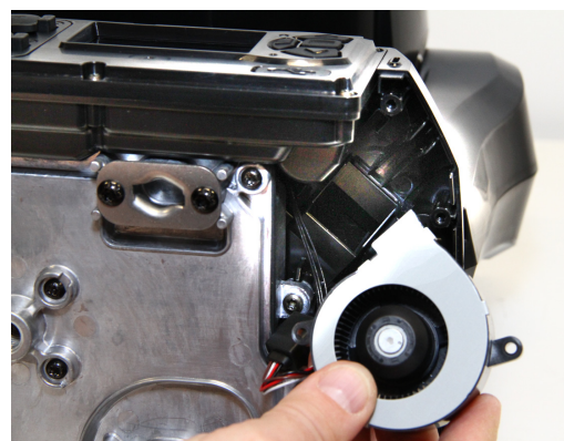
Figure 11: Déplacement de la turbine
